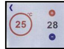
Einfache Temperaturswahl mit aktueller Kabinentemperatur (links) und verstellbarer Zieltemperatur (rechts)
