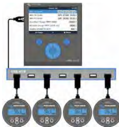
Battery Balancer (BMS012201000) Der Battery Balancer (Ladungszustandsausgleicher) gleicht den Ladezustand von zwei in Serie geschalteten 12V Batterien oder von mehreren parallele Strängen von in Serie geschalteten Batterien aus. Wenn die Ladespannung eines 24V-Batteriesystems auf über 27V ansteigt, schaltet sich der Battery Balancer ein und vergleicht die Spannung bei den zwei in Serie geschalteten Batterien. Der Battery Balancer entnimmt der Batterie (oder den parallel geschalteten Batterien) mit der höchsten Spannung einen Strom von bis zu 1A. Der daraus resultierende Unterschied beim Ladestrom sorgt dann dafür, dass sich alle Batterien an denselben Ladezustand angleichen.
