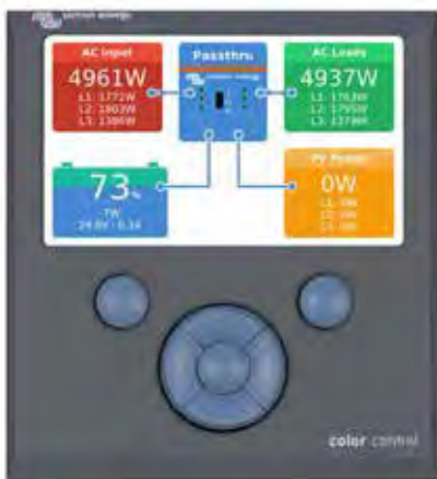
Color Control Panel, mit Anzeige eines PV-Systems
