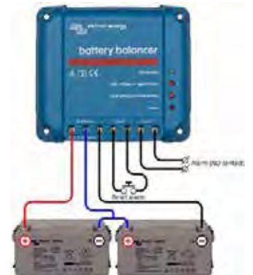
Battery Balancer (BMS012201000) Der Battery Balancer (Ladungszustandsausgleicher) gleicht den Ladezustand von zwei in Serie geschalteten 12V Batterien oder von mehreren parallele Strängen von in Serie geschalteten Batterien aus. Wenn die Ladespannung eines 24V-Batteriesystems auf über 27V ansteigt, schaltet sich der Battery Balancer ein und vergleicht die Spannung bei den zwei in Serie geschalteten Batterien. Der Battery Balancer entnimmt der Batterie (oder den parallel geschalteten Batterien) mit der höchsten Spannung einen Strom von bis zu 1A. Der daraus resultierende Unterschied beim Ladestrom sorgt dann dafür, dass sich alle Batterien an denselben Ladezustand angleichen.
