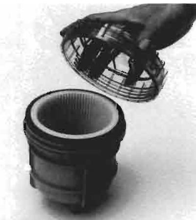
Überprüfen des Kühlwasserfilters. Contrôle du filtre à eau de refroidissement.
