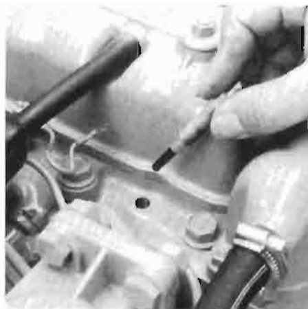
Gloeipluggen verwijderen. Removal of glow plugs.
