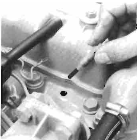
Glühkerzen entfernen. Dépose des bougies incandescentes.
