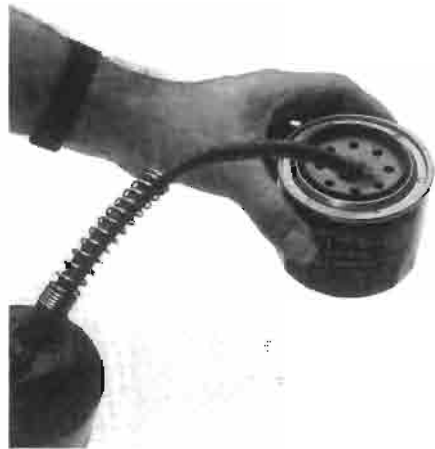
Inoliën rubber ring. Oiling the oil seal.
