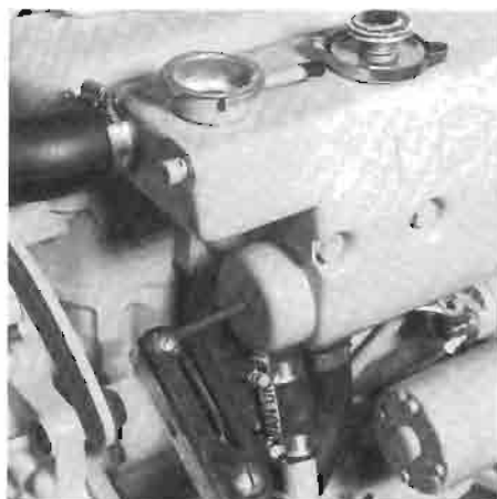
Entfernen der mittleren Bolzen aus den Enddeckeln. Démontage du boulons central du couvercle de retenue.
