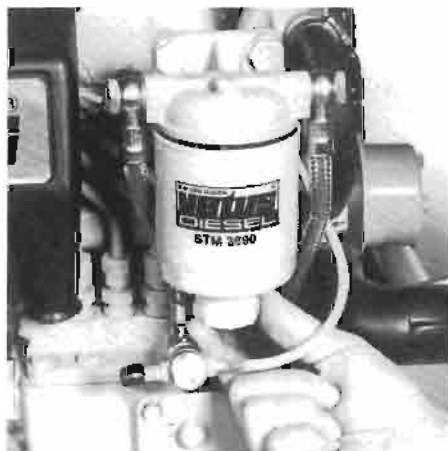
Wasserabscheider entleeren. Purge du séparateur d'eau.
