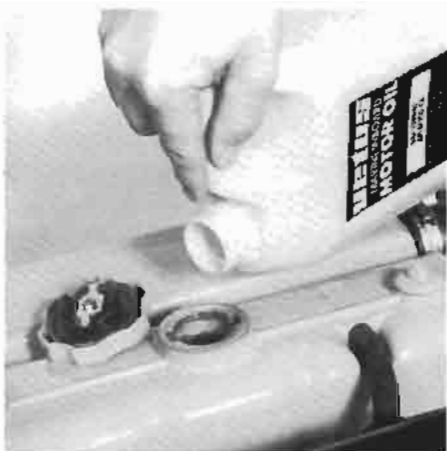
Einfüllen des Öls. Le remplissage.
