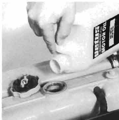
Olie bijvullen. Topping up oil.
