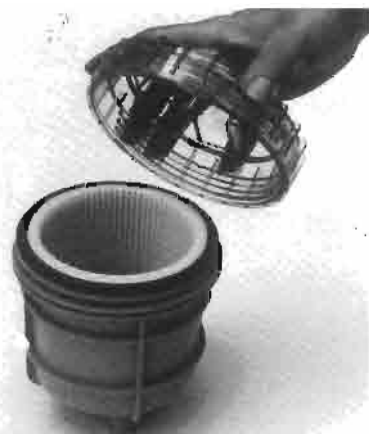
Kontrolle des Kühlwasserfilters. Contrôle du filtre à eau de refroidissement.
