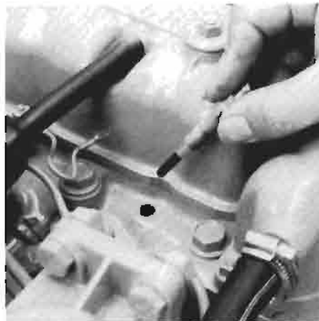
Retirar las bujías incandescentes. Rimozione delle candele a incandescenza.
