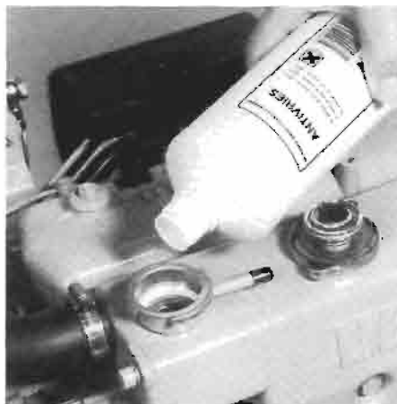
Bijvullen koelsysteem. Topping up coolant.
