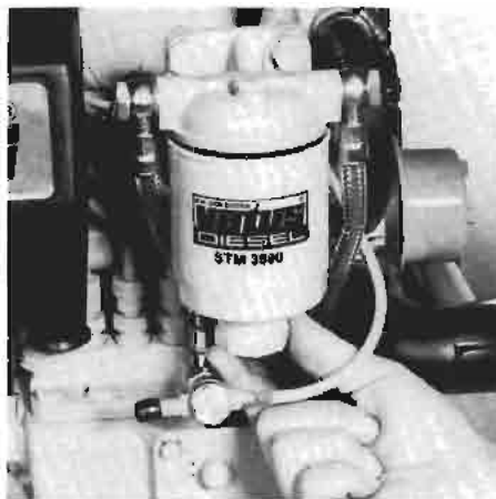
Desaguar el separador de agua. Scaricare dell'acqua dal separatore dell'acqua.
