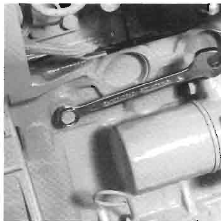
Entfernen der Ablassschrauben. Dépose de bouchons de purge.
