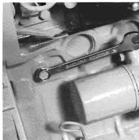
Retirar el tapón de vaciado. Rimozione dei tappi di scarico.
