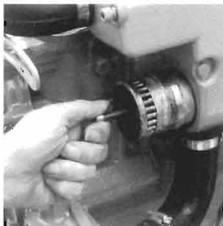
Uitnemen warmtewisselaar. Remove heat exchanger.
