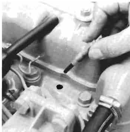
Gloeipluggen verwijderen. Removal of glow plugs.
