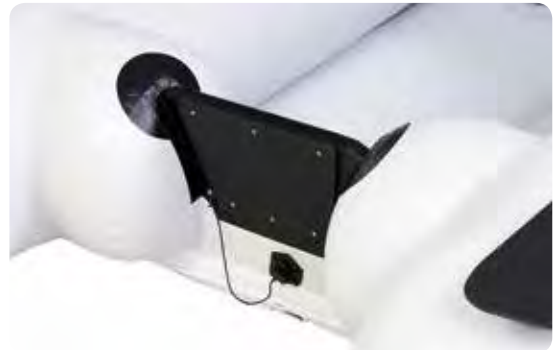
Versteifungen im Bereich des Spiegels sorgen für eine verkleinerte Spiegelplatte und somit einem leichten Tender der gut zu verstauen ist.
