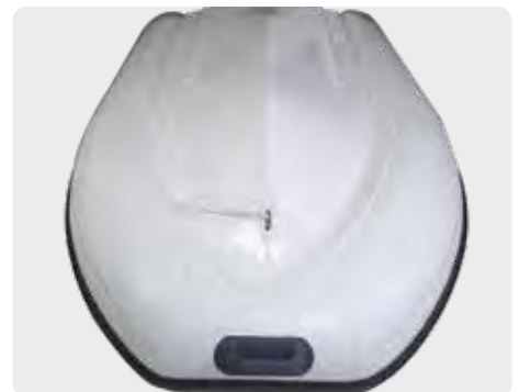
V-förmiger Polyesterrumpf verfügt über zwei Rippen für erhöhte Stabilität und sichere Kurvenfahrten.
