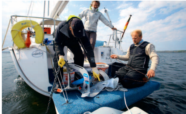
Anker und Geschirr werden auf der großen Heckplattform vorbereitet, dann per Dingi an definierten Positionen ausgebracht
