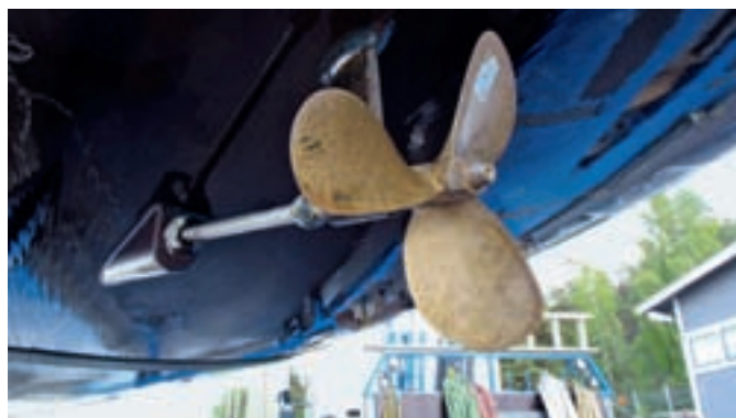
Lästiger Bremsklotz. Der Festpropeller (oben) bietet sichtlich Widerstand. Der Faltprop dagegen ist strömungsgünstig
