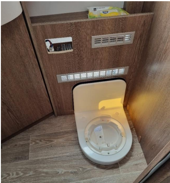
L-Adapter platziert, Serviceöffnung komplett abgedeckt
