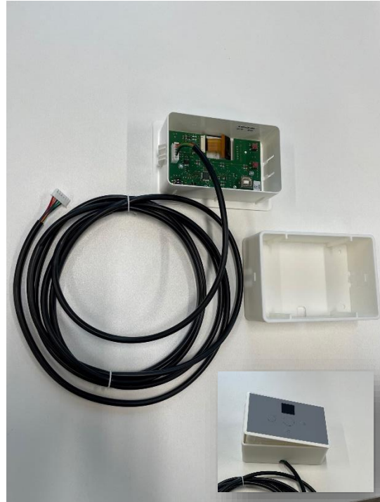
C1 Display (Rückansicht) mit Kabel und Aufputz-Gehäuse
