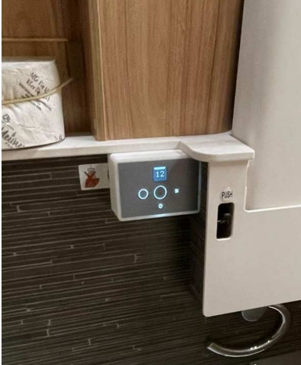
C1 Display installiert mittels Aufputz-Gehäuse
