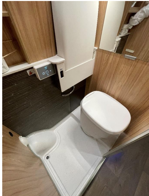
Duschwanne angepasst & Clesana C1 nachgerüstet (Variante 2)
