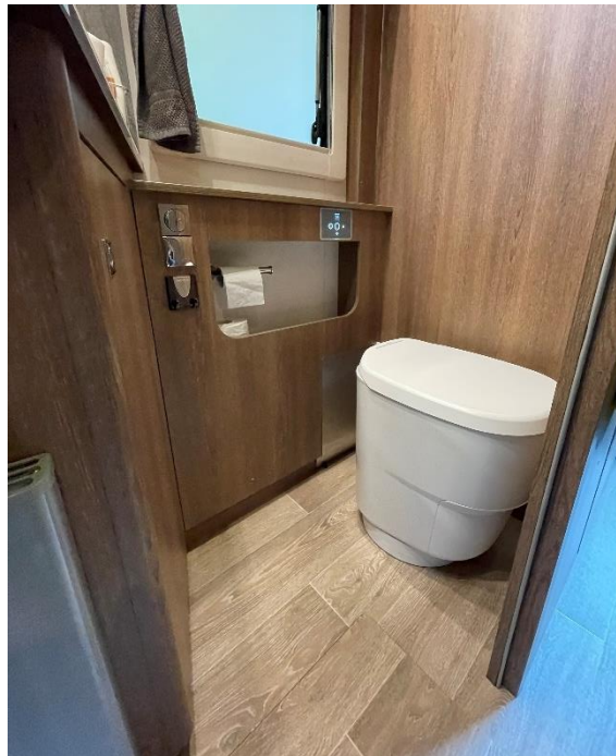
C1 auf Rund-Sockel, Serviceöffnung vertäfelt, Aussparung für Display in Möbel geschnitten
